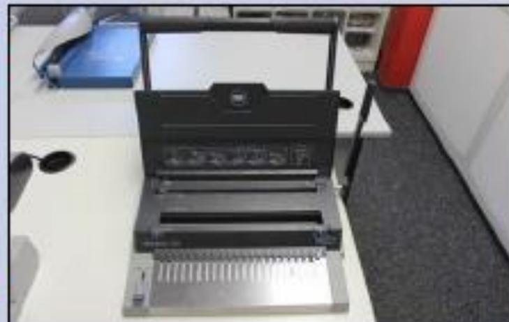
2. Spiralbindung einlegen (befindet sich im rechten Schrank) und Hebel 2 leicht zu sich hinziehen, so dass die Bindung sich öffnet. Es ist darauf zu achten, dass die Bindung sich oben aufziehen lässt (beim falschen Einlegen funktioniert das „Aufziehen“ nicht).
