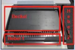
2. Spiralbindung einlegen (befindet sich im rechten Schrank) und Hebel 2 leicht zu sich hinziehen, so dass die Bindung sich öffnet. Es ist darauf zu achten, dass die Bindung sich oben aufziehen lässt (beim falschen Einlegen funktioniert das „Aufziehen“ nicht).
