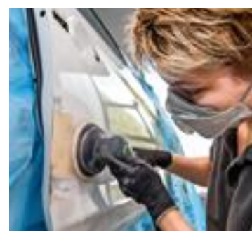
Auf Kleinigkeiten achten: Janina Uhlig schleift ausgespachtelte Dellen vor dem Lackieren glatt.
